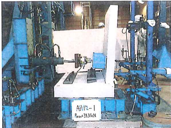
写真1 破壊状況 試験体記号：AW12-1 Pmax=33.3 kN ・全景
